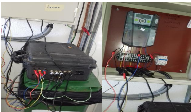
Slika 1 – Mrežni analizator na mestu merenja
